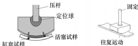
图 6 试样夹紧与自定位装置
